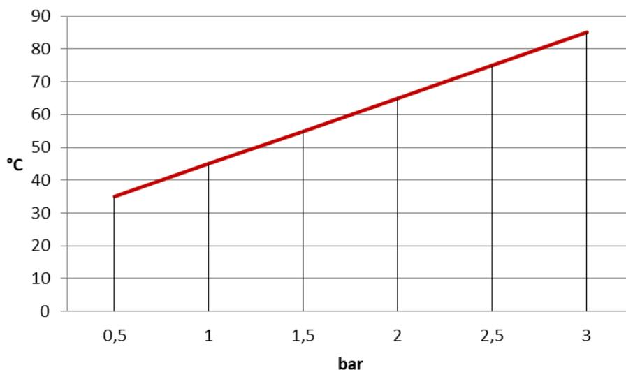
È da rilevare come una pressione di alimentazione di 3 bar anche a temperature del liquido basse (ad esempio 45°C) fanno sì che la vita della pompa (guarnizioni e valvole), sia ancora più lunga.
