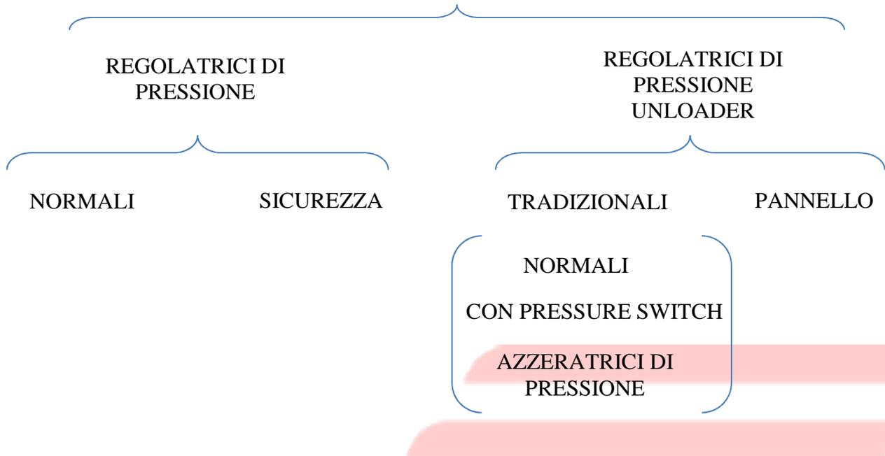
**VALVOLA REGOLATRICE DI PRESSIONE UNLOADER CON PRESSURE SWITCH:** Valvola regolatrice di pressione, connessa ad un interruttore elettrico, di tipo elettromeccanico, che alla chiusura della pistola, apre o chiude un contatto elettrico di comando. Alla chiusura della pistola il flusso dell'acqua viene bypassato a bassa pressione.
